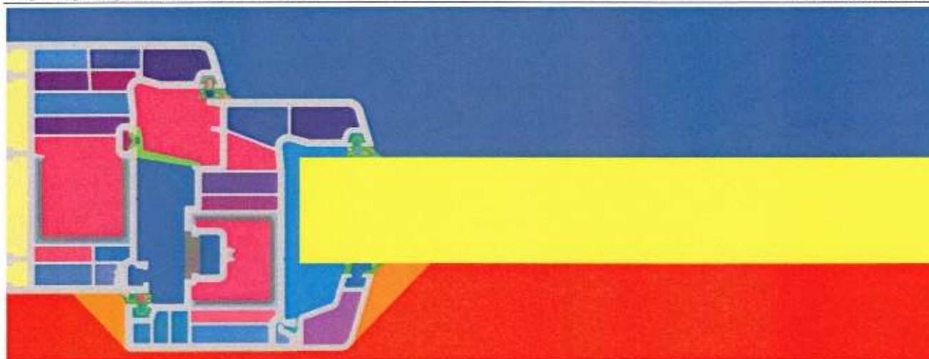
Slika 7: 2-D model za proračun koeficijenta prolaska topline U_{f,A} za presjek A-A sustava profila ostakljenog trostrukim IZO staklom debljine 36 mm. Ukupna širina slike je 3140 piksela (u modelu 314 mm), ukupna visina 1200 piksela (u modelu 120 mm).
