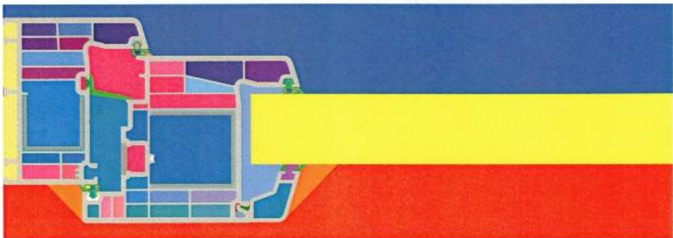
Slika 3: 2-D model za proračun koeficijenta prolaska topline U_f za presjek A-A sustava profila ispune PVC panelom debljine 36 mm. Ukupna širina slike je 3410 piksela (u modelu 341 mm), ukupna visina 1200 piksela (u modelu 120 mm).
