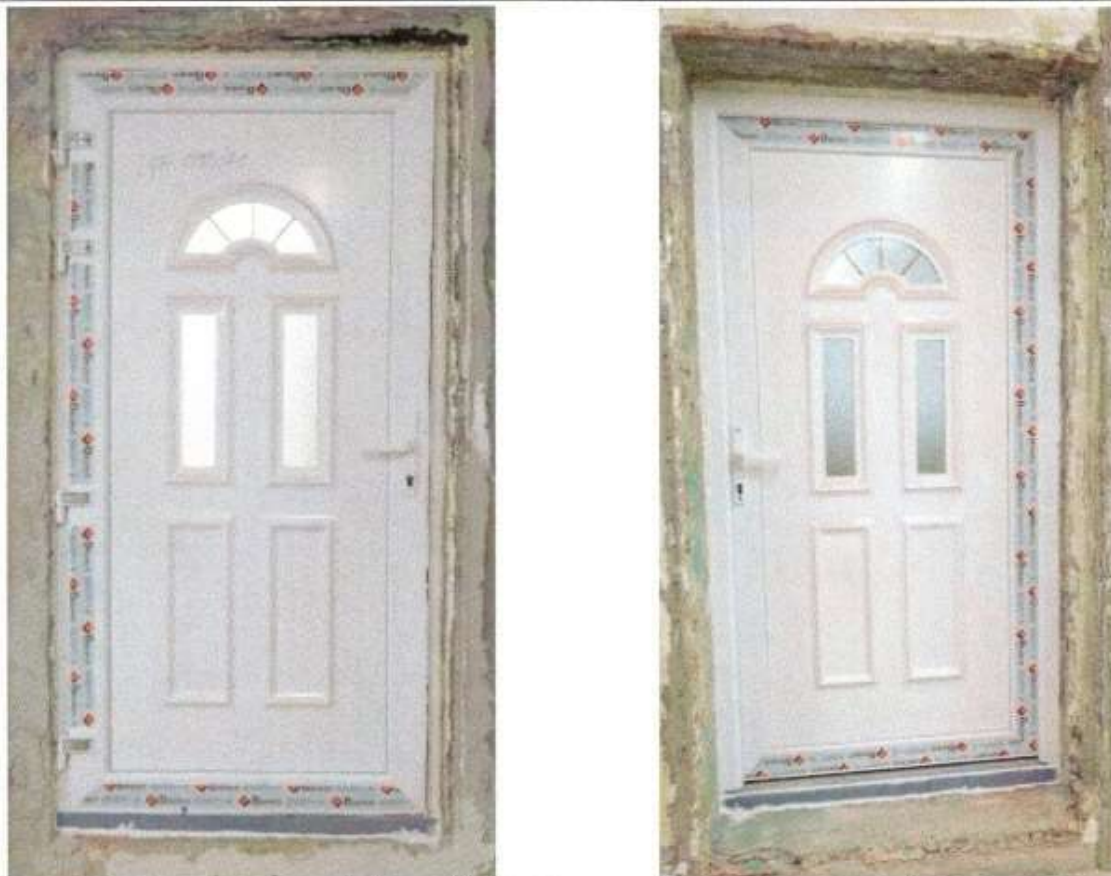
Fotografije ispitnog uzorka iz predajne i prijemne prostorije neposredno prije ispitivanja
